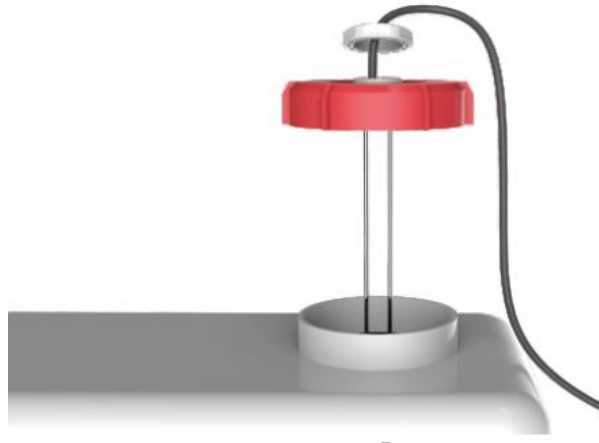
Figure 3-3 Insertion de la vis d'assemblage de la sonde RSE-A dans le câble
