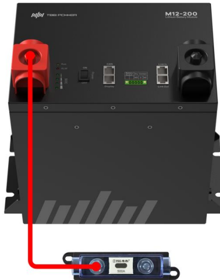
Figure 2-8 Connexion du câble d'alimentation à la borne (+) de la batterie lithium
