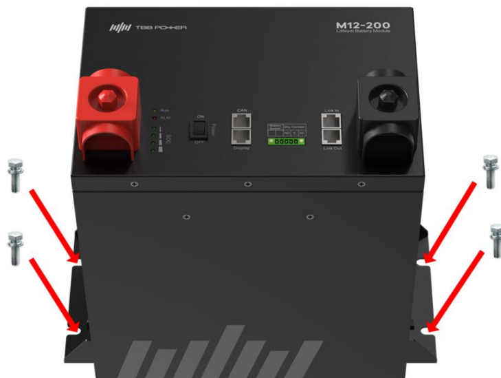
Bild 3-2 Befestigung der Lithium-Batterie
